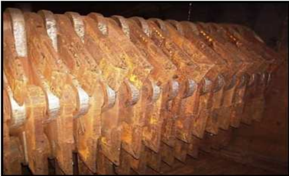
Fonte: http://pimartins.weebly.com/recepccedilatildeo-e-preparo.html (2014). FIGURA 9 – Picador de cana com facas oscilantes “COP 8”
